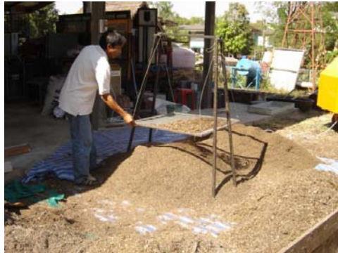
รูปที่ 3 แสดงการร่อนเพื่อแยกส่วนหยาบและละเอียด
